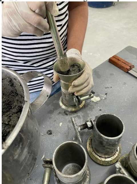
Figura 3 – Processo de moldagem de corpos de prova
