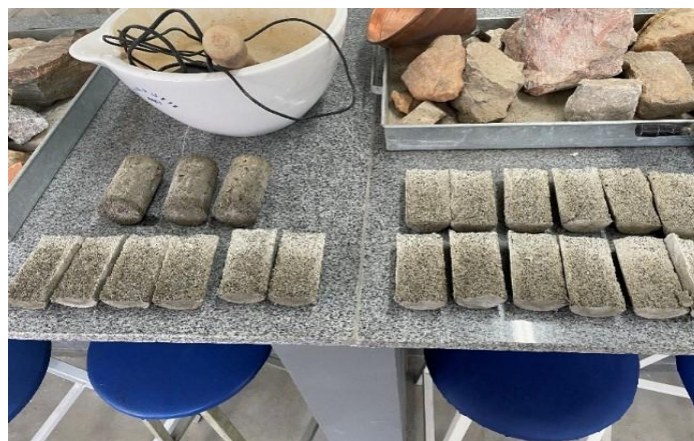
Figura 5 – Corpo de prova após ruptura longitudinal
