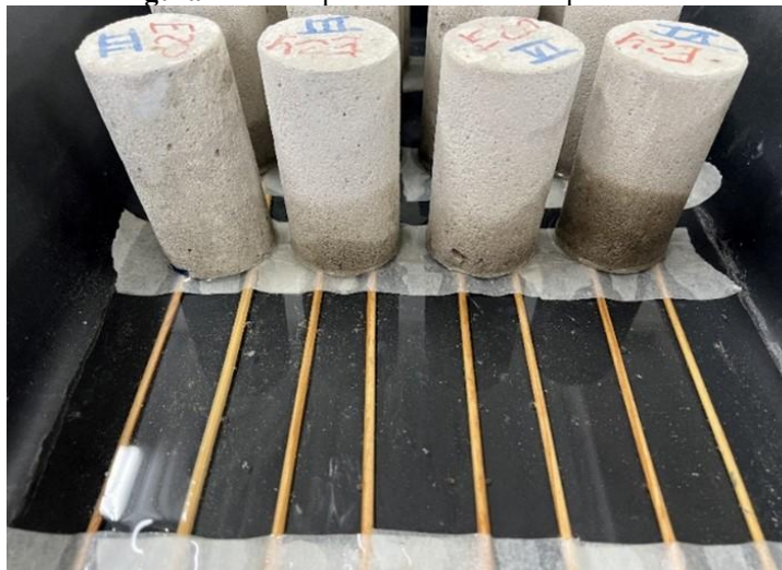
Figura 4 – Vista parcial do teste de capilaridade
