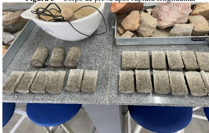
Figure 5 - Test Specimen after longitudinal rupture Figura 5 – Corpo de prova após ruptura longitudinal
