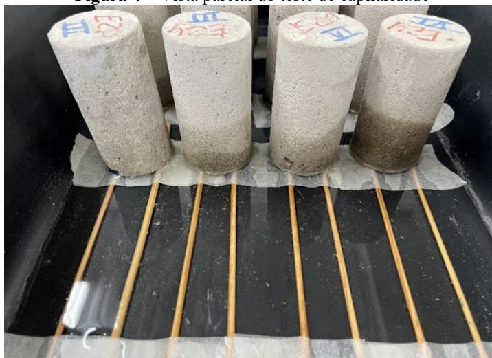
Figure 4 - Partial View of the Capillary Action Test Figura 4 – Vista parcial do teste de capilaridade
