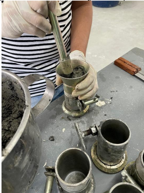
Figure 3 - Test specimen molding process Figura 3 – Processo de moldagem de corpos de prova
